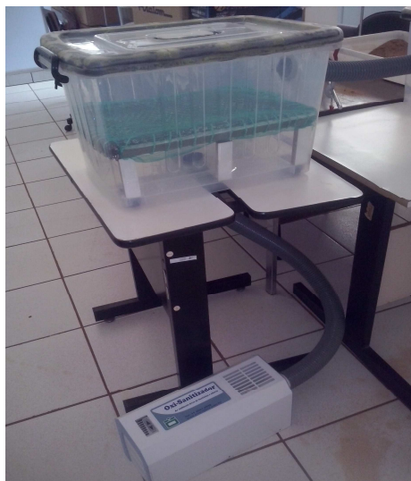
Figura 2. Esquema para o processo de ozonização (equipamento gerador de ozônio acoplado ao fundo do primeiro recipiente).
